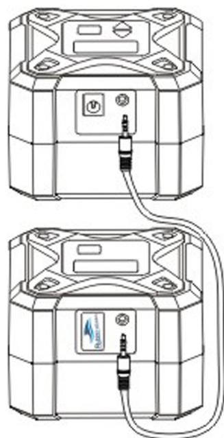
Use o conector que vem junto com o TS2. Um conector vai na bomba 2 na parte de trás, e o outro via na bomba 1 na parte de trás.
